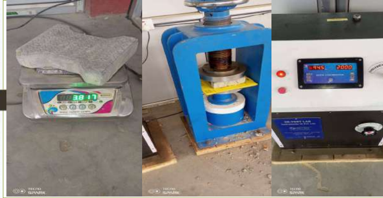
देवदह नगरपालिकाको आफ्नै ल्याबमा ब्लकको Strength टेष्ट गर्दै ।
