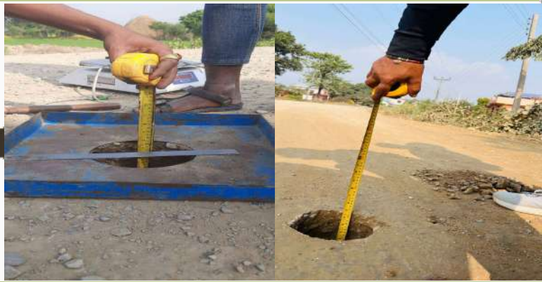
Field Density Test गर्दै गर्दाको नमुना तस्बिरहरु ।
